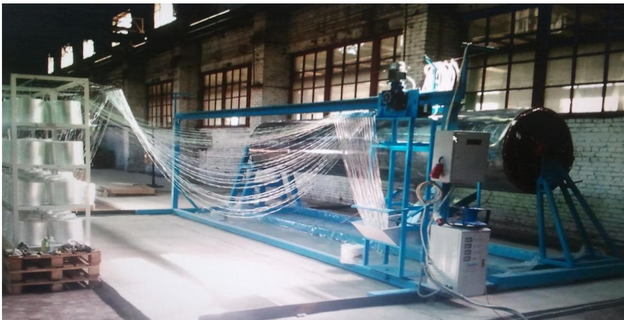
Оборудование для изготовления стеклопластиковых труб, емкостей и других тел вращения по технологии намотки состоит из следующих составляющих:
